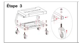
Alignez les montures latérales avec les supports de plateau en métal tel qu'illustré. Les roulettes seront installées lorsque les trous sont alignés. L'écrou sur l'assemblage de roulettes s'emboîtera dans le trou carré percé dans la cuvette du plateau en métal inférieur.
